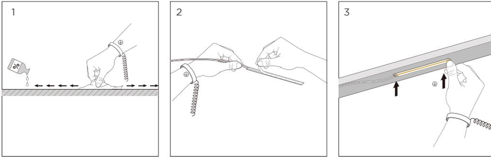
如图1所示，用布清洁要连接的环境部分，然后撕下灯带背面的3M胶带，最后将灯带粘在干净的地方。
