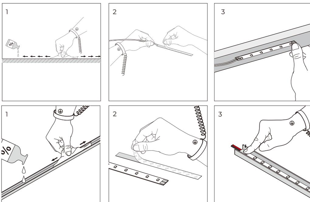
如图1所示，用布清洁要连接的环境部分，然后撕下灯带背面的3M胶带，最后将灯带粘在干净的地方。
